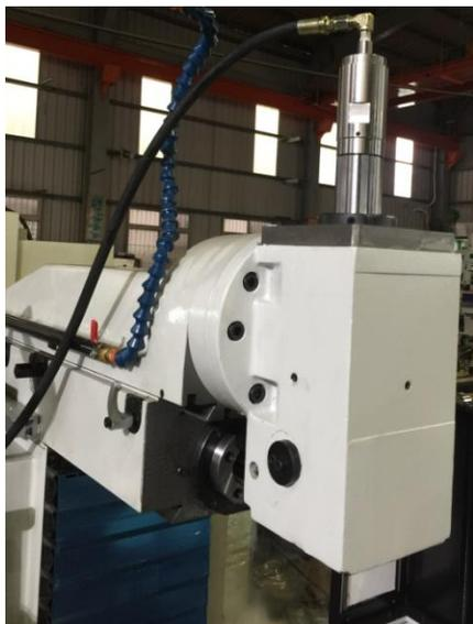
3. LSG-400D Sicherheitsabdeckung für Horizontal-/Vertikalspindelenschutz
